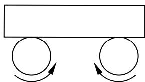
2 двигателя в противоположном направлении = линейные вибрации
