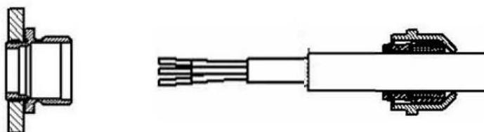
Изолируйте внешнюю оболочку кабеля. На кабель насадите закрывающую гайку и зажимной ковш.
