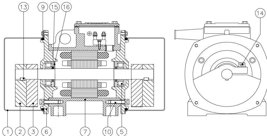
1. Снимите оба защитных кожуха (1). Отметьте положение поворотных внутренних центробежных масс (3). Ослабьте закрепляющие болты (14) центробежных масс.
