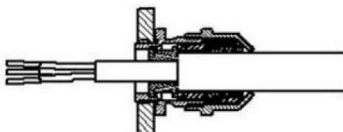
Кабель с отдельными частями протяните через установленную муфту. Закрывающую гайку затяните затягивающим моментом, соответствующим его размеру.
