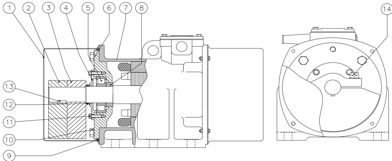
1. Снимите оба защитных кожуха (1). Отметьте положение поворотных внутренних центробежных масс (3). Ослабьте закрепляющие болты (14) центробежных масс.
