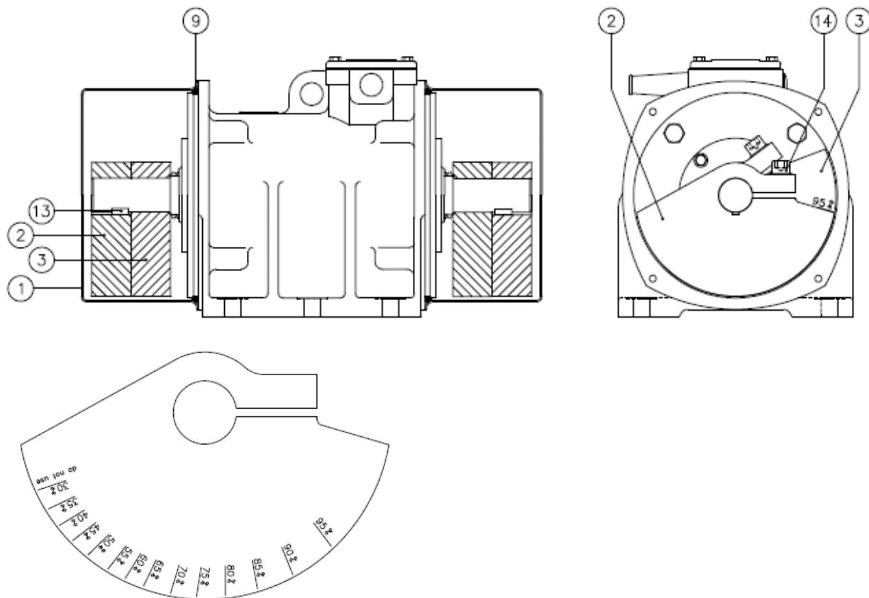
Вибрационные двигатели, серийно поставляются с установленным показателем центробежных сил 100%.
