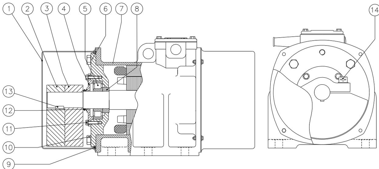
1. Enlever les deux capots de protection (1). Marquer la position des disques centrifuges intérieurs rotatifs (3) ou la noter. Desserrer les vis de fixation (14) des disques centrifuges.
