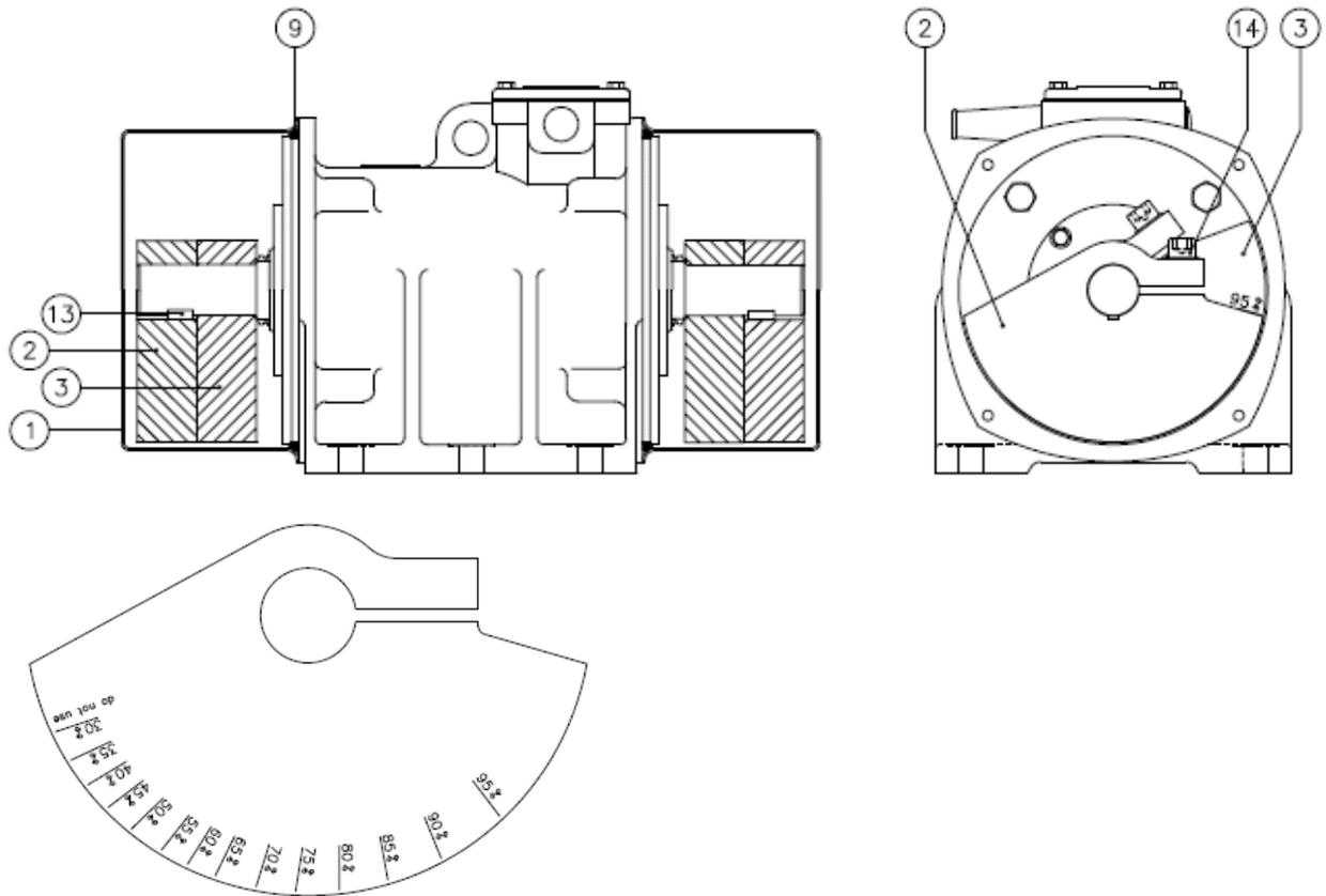
Les moteurs vibrants sont livrés en standard avec un réglage de force centrifuge à 100 % départ usine.
