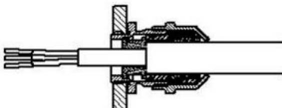
Passez le câble avec les pièces particulières par la douille montée. Serrez l'écrou de revêtement avec le couple de serrage correspondant à sa grandeur.
