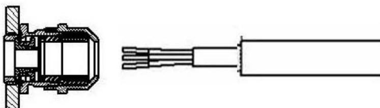
Montez le raccord de câble. Serrez bien la douille.
