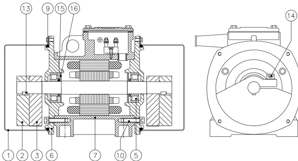
1. Enlever les deux capots de protection (1). Marquer la position des disques centrifuges intérieurs rotatifs (3) ou la noter. Desserrer les vis de fixation (14) des disques centrifuges.
