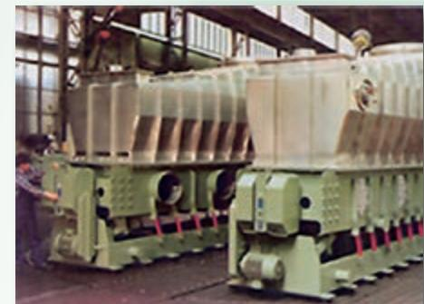
Grâce au graissage à l'huile, les excitateurs de déséquilibre sont notamment appropriés pour l'utilisation à des températures élevées, par exemple dans les sécheurs.
