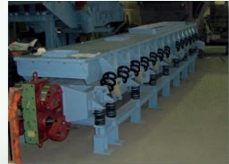
Les excitateurs de déséquilibre peuvent être montés sous n'importe quel angle, comme p.e. sur ce tablier de réception de fonderie sous l'angle 0°.
